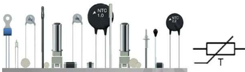
Рис. 11. Терморезисторы и их обозначение
